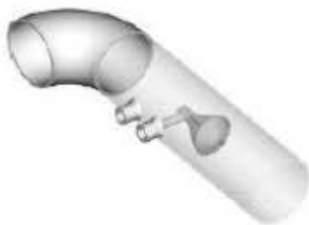
图4：单弯管和环锥流量计
